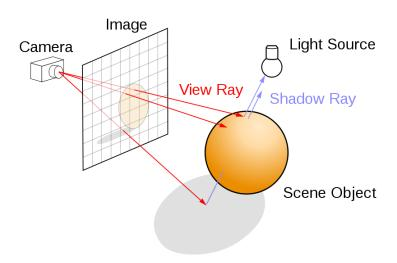
Il faut considérer que l'image finale affichée à l'écran est représentée par un Quad placé dans la scène juste devant la caméra, et que la caméra va lancer des rayons à travers chaque pixel de l'image et détecter les intersections avec les objets de la scène.
